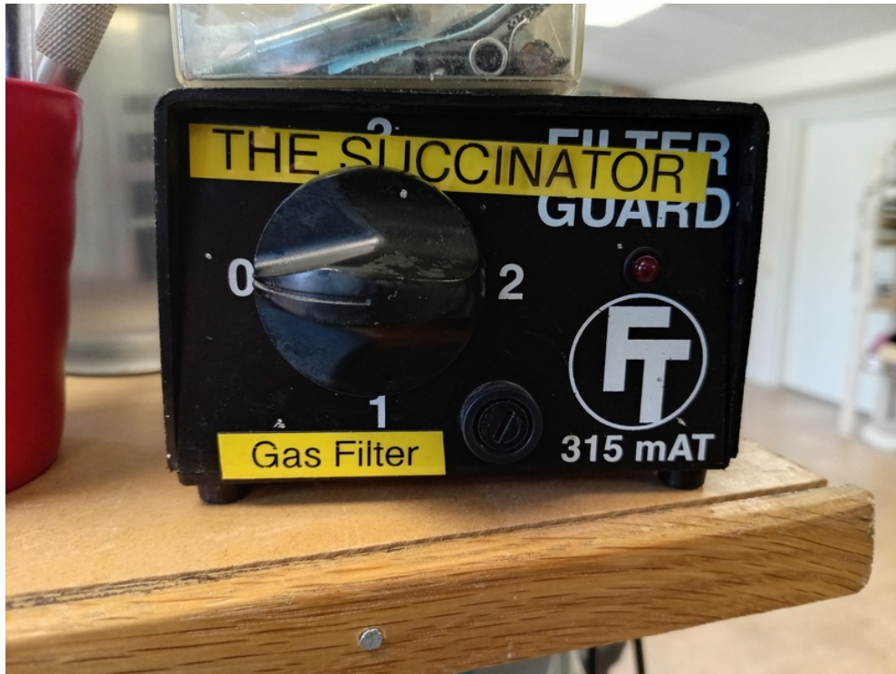
Figure 11: Sätt på ångutsugningen med att vrida knappen till två
