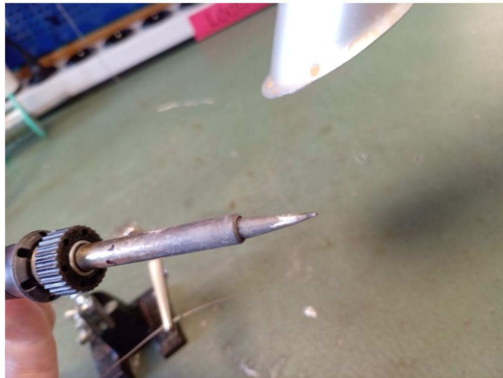
Figure 16: Lödningsjärnet har ingen silverspets
