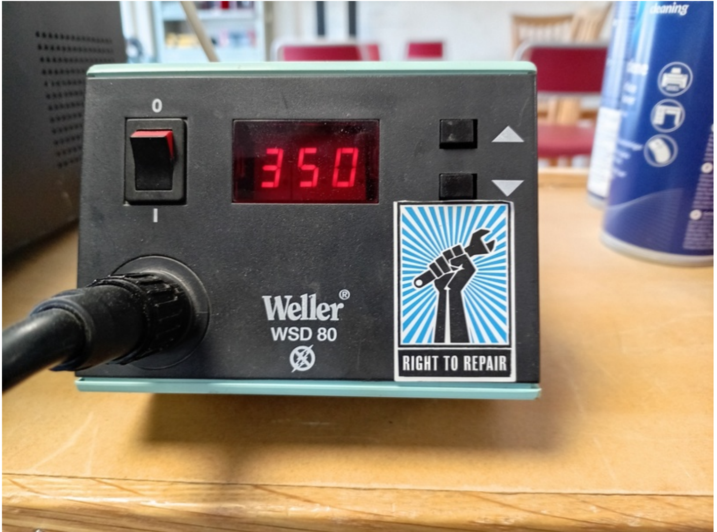
Figure 12: Sätt temperaturen på 350 grad Celsius
