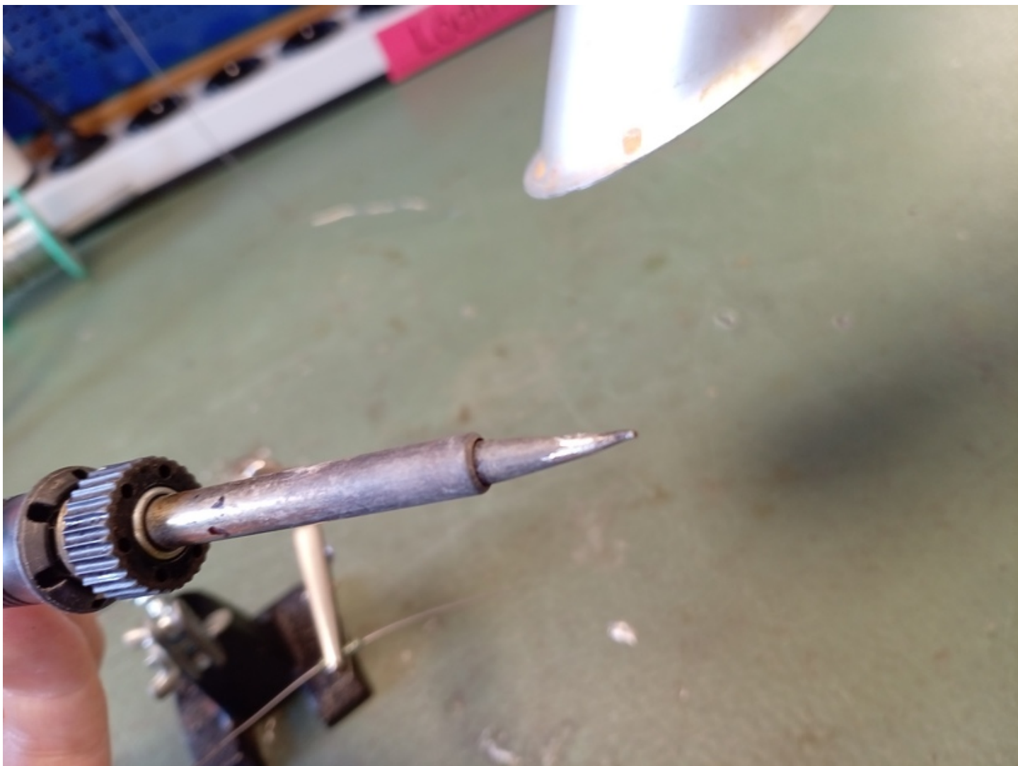
Figure 16: Lödningsjärnet har ingen silverspets
